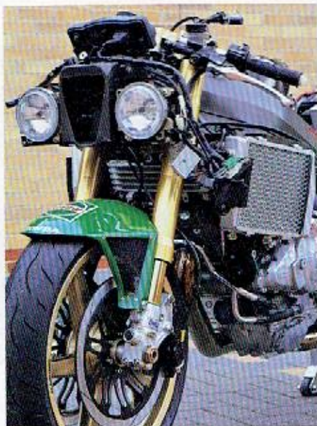
Gros plan sur le tunnel en fibre de carbone (plus volumineux de 15%) qui mène à la boîte à air. Les optiques proviennent d'une Honda 400 VFR.
